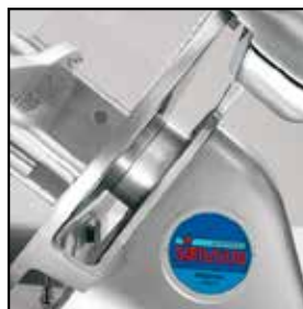
Dostatečný prostor mezi nožem a motor. blokem pro každodenní údržbu.
